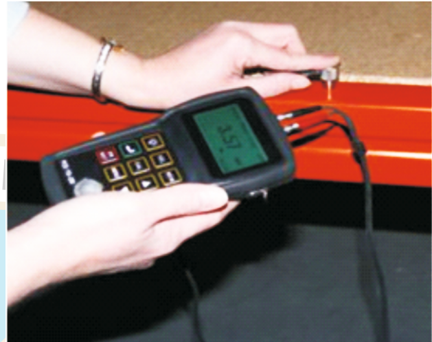
Figura 11.- Ensayos no destructivos
